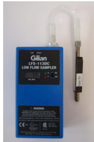
Figure 22: Pompe de prélèvement LFS 113 munie d'un tube de prélèvement Carbotrap™ 349
