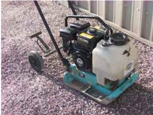
Plaque vibrante avec roues de manutention
